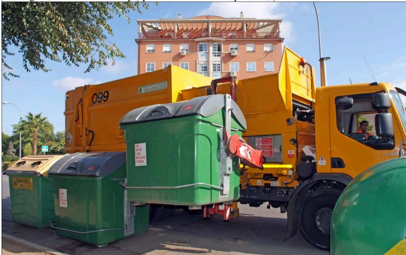
Recolector-compactador de Carga Lateral que utiliza combustible biodiesel
