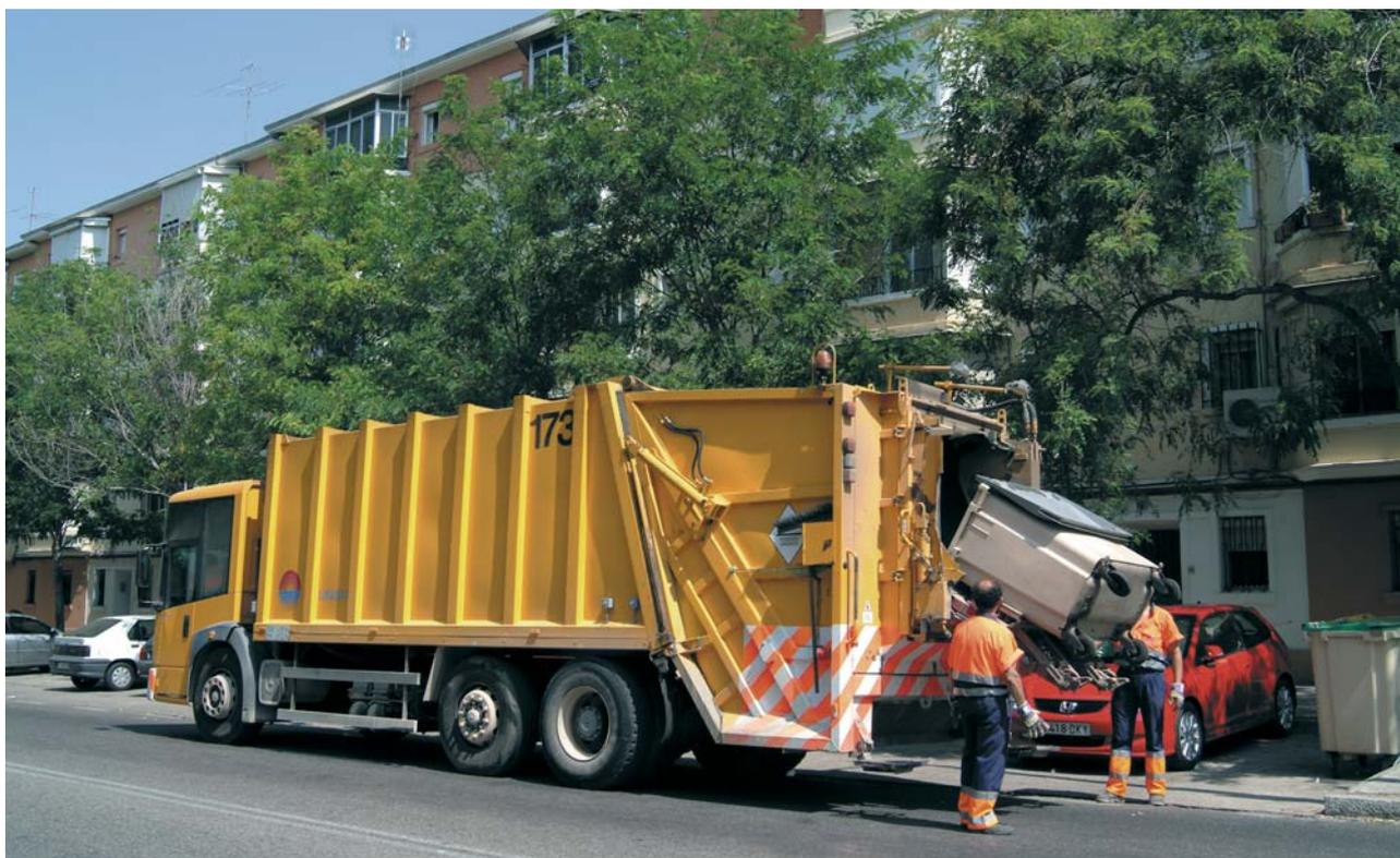
■ Equipo de Recogida de Residuos mediante Carga Trasera
